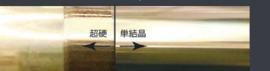
ADC12 Φ20外径仕上加工
